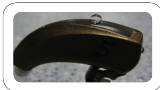
Figure 6 : HydraShield ®2 présente toujours une superhydrophobie après deux cycles de brouillard salin.
