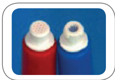
Figure 5 : Le nouvel outil de la protection pare-cérumen Hear Clear est rouge, celui d'origine est bleu.
