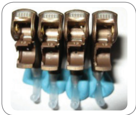
Figure 7 : Aucune corrosion n'a été observée au niveau du tiroir pile ni de la zone des contacts de l'Entrée Directe Audio, après deux cycles de brouillard salin.
