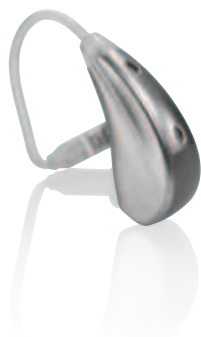
Figure 1 : Aide auditive RIC avec technologie Tinnitus Multiflex.
